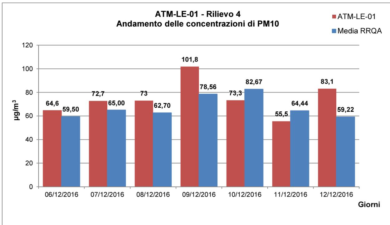
Fig. 2.2/E – Andamento delle concentrazioni di PM10 presso la postazione ATM-LE-01 e presso le centraline ARPA dal 06/12/2016 al 12/12/2016
