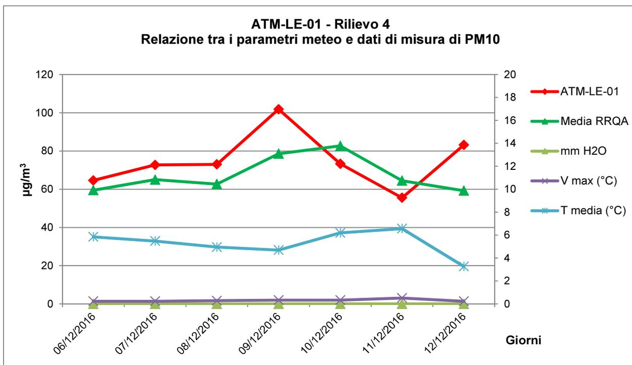
Fig. 2.2/F – Andamento delle concentrazioni di PM10 e dei parametri meteo presso la postazione ATM-LE-01 e presso le centraline ARPA dal 06/12/2016 al 12/12/2016
