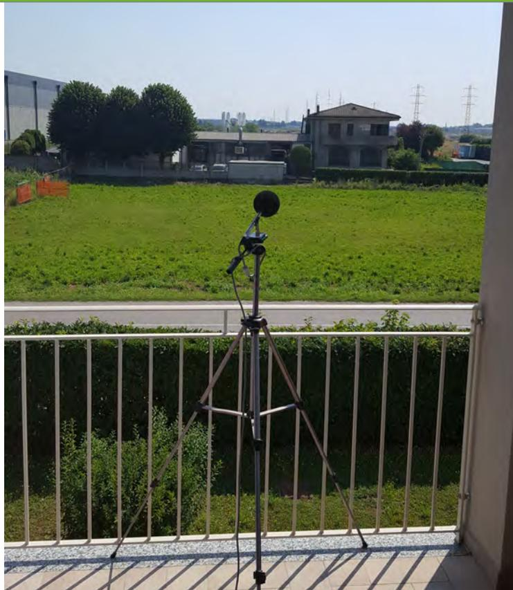
Foto 1 Foto attività di rilievo: fonometro installato
